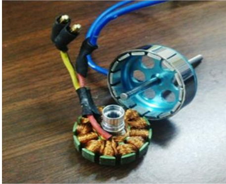
Figura 7.11 Pamje e brëndëshme e motorit BLDC me rrotor të jashtëm
