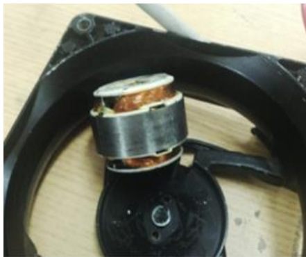
Figura 7.13 a) pamja e motorit AC pasi janë hequr fletet e ventilatorit. b) Transmisioni elektrik me motor BLDC
