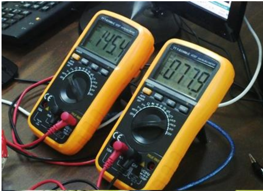
Figura 11. Multimeter digital, të përdorur për të matur rrymën dhe tensionin
