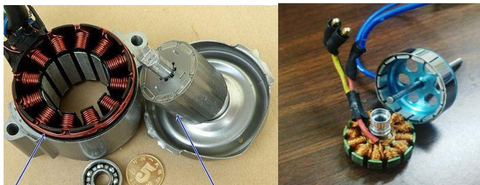
Figura 2.5 Motor BLDC me a) rrotor të brendshëm, inrunner motor me 4 çifte polesh, 2. me rrotor të jashtëm, outrunner motor , me 7 çifte polesh
